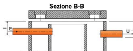
Sezione coperchio per fosse DN 1000
