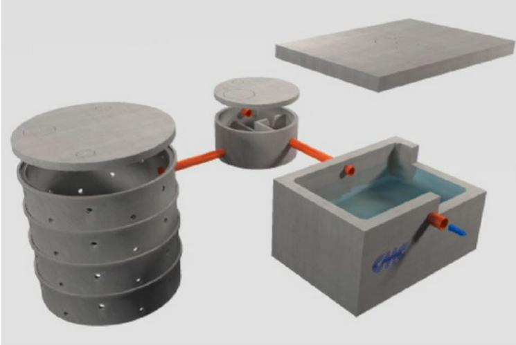
Impianti di prima pioggia costituiti da vasche prefabbricate, realizzate in calcestruzzo vibrato armato con finitura industriale, idonei per la separazione per gravità delle acque meteoriche di prima pioggia con accumulo e smaltimento differito nella rete fognaria dopo un periodo di tempo asciutto prestabilito e con dispersione delle acque di seconda pioggia attraverso pozzi disperdenti.
