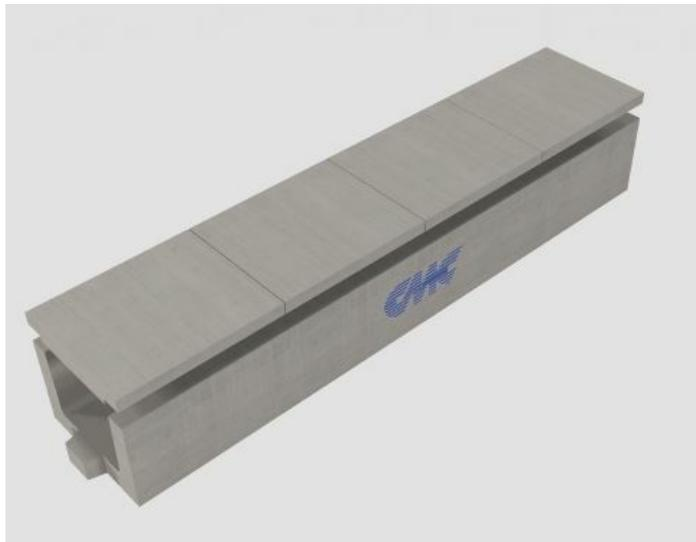
Canalette prefabbricate realizzate in calcestruzzo vibrato con finitura industriale idonee per il passaggio di cavi o polifere, prodotte con o senza incastro maschio-femmina tra gli elementi, ad una o più vie in un unico getto a seconda della dimensione utile interna e disponibili con o senza coperchio carrabile o pedonabile.
