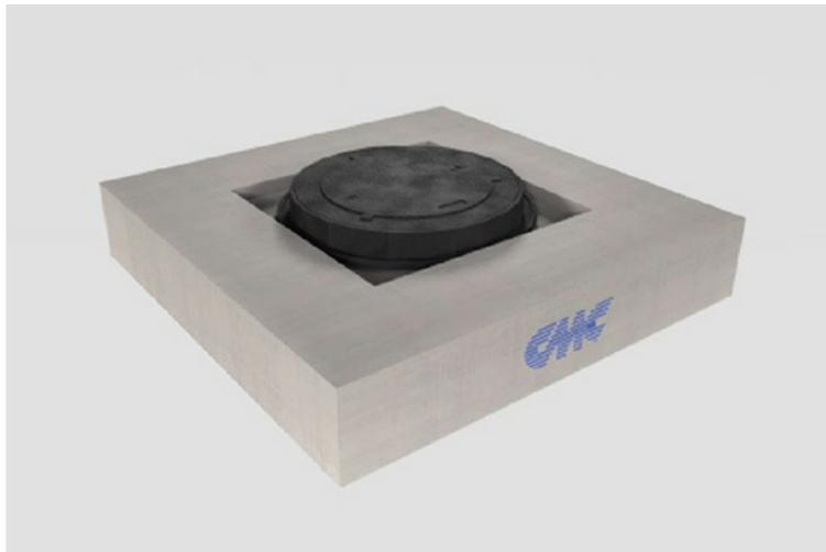
Solette di chiusura speciali dimensionate per sopportare carichi di grande entità, realizzabili su commessa in calcestruzzo armato con finitura industriale per camerette di sezione circolare, quadrata o rettangolare e munite di foro passante per l'appoggio superiore di un chiusino in ghisa o in calcestruzzo.
