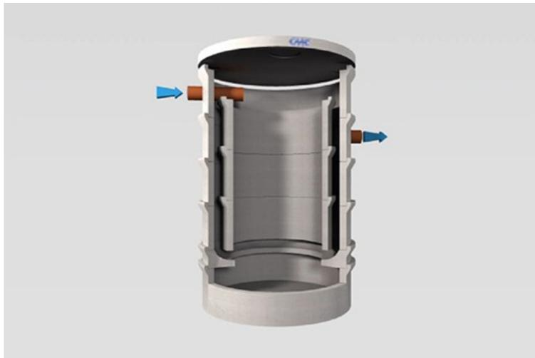
Degrassatori prefabbricati realizzati in calcestruzzo armato vibrato con finitura industriale, ideati alla separazione per gravità degli ammassi di materiale galleggiante prodotti dalla combinazione di oli, grassi e detersivi.
