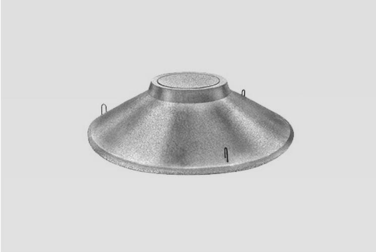
Coperchi carrabili per traffico leggero di forma tronco-conica, realizzati in calcestruzzo armato con finitura industriale muniti di foro superiore dotato di tappo incorporato in calcestruzzo.
