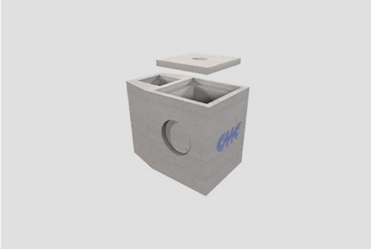
Pozzetti prefabbricati muniti di camera di sifonamento, realizzati con fondo incorporato e disponibili in due diverse tipologie in funzione del diametro nominale del tubo pluviale in ingresso, destinati a raccogliere e convogliare acque meteoriche per gravità provenienti dai pluviali di coperture.
