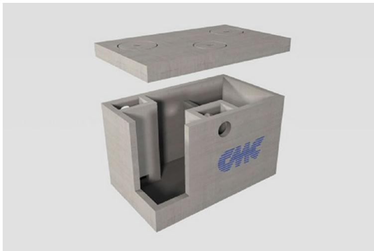
Disoleatore/dissabbiatore prefabbricato idoneo alla separazione di liquidi leggeri per gravità e alla raccolta di sabbie e altri materiali pesanti, realizzato in calcestruzzo armato vibrato con finitura industriale.
