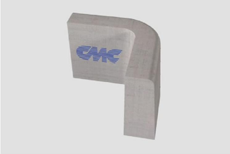
Cordoli curvi realizzati in calcestruzzo gettato faccia a vista ideati per aree soggette al traffico veicolare in conformità alla norma UNI EN 1340, aventi sezione trapezoidale, muniti di smusso arrotondato sugli spigoli frontali e dotati di incastro maschio-femmina in testa.
