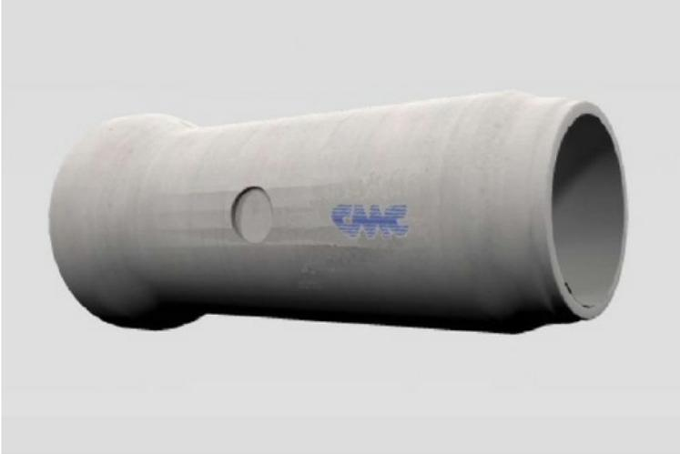
Tubazioni prefabbricate vibro-compresse a sezione interna circolare con incastro a bicchiere e spessore incrementato, conformi alla norma UNI EN 1916 e idonee al convogliamento delle acque di fognatura, meteoriche e superficiali.
